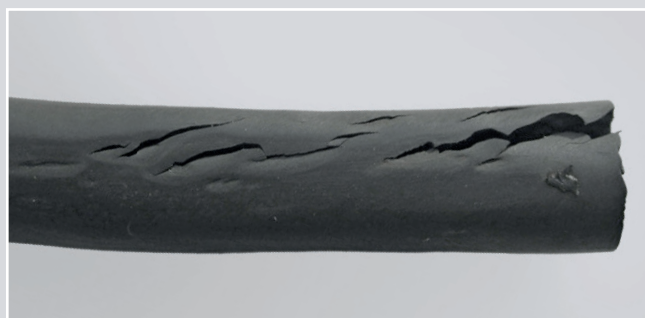
Aumento dell'anello di guarnizione convenzionale, che presenta evidenti danni a causa di una decompressione esplosiva.
